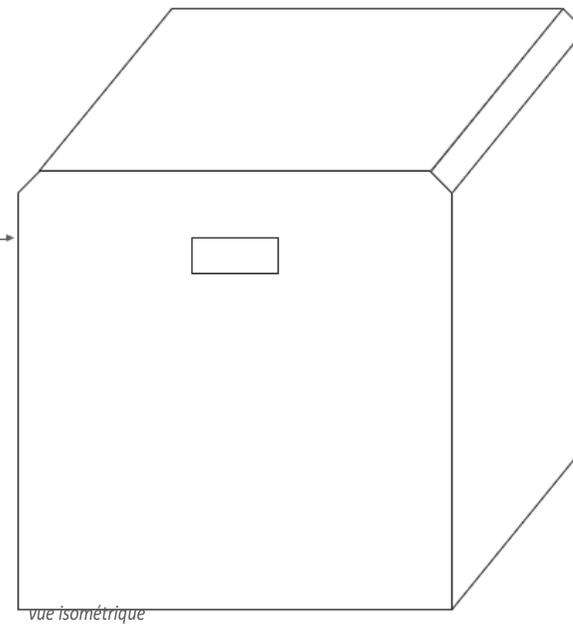
Fabriqué dans une plaque d'aluminium de 3mm d'épaisseur, unité entièrement soudée (à l'arc) & peinte à la poudre en jaune RAL 1023
